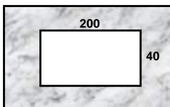
5. A la placa de metal mostrada se le ha aplicado un orificio como muestra la figura. Hallar cuál será el área final de dicho orificio si calentamos a la placa en  $100^{\circ}\text{C}$ . Considere:  $\beta = 10^{-3}$ .
