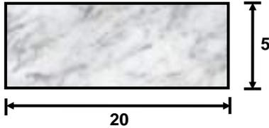
2. La figura muestra una placa que se encuentra a  $10^{\circ}\text{C}$ . Si esta placa es calentada hasta la temperatura final de  $80^{\circ}\text{C}$ , hallar el área final respectiva que tendrá. Considere :  $\beta = 3 \cdot 10^{-4}$ .
