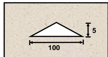
4. A la placa de metal mostrada se le ha aplicado un orificio como muestra la figura. Hallar cuál será el área final de dicho orificio si calentamos a la placa en  $50^{\circ}\text{C}$ .
