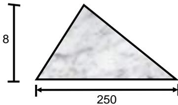
3. La figura muestra una placa que se encuentra a  $6^{\circ}\text{C}$ . Si esta placa es calentada hasta la temperatura final de  $206^{\circ}\text{C}$ . Hallar el área final respectiva que tendrá. Considere :  $\beta = 5 \cdot 10^{-4}$ .
