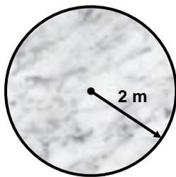
4. A la placa de metal se le ha aplicado un orificio como muestra la figura. Hallar cuál será el área final de dicho orificio si calentamos a la placa en  $10^{\circ}\text{C}$ . Considere:  $\beta = 2 \cdot 10^{-4}$ .
